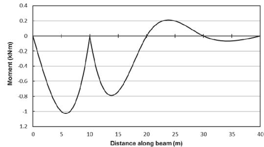
(d) Interior Support Moment – 4-span continuous
