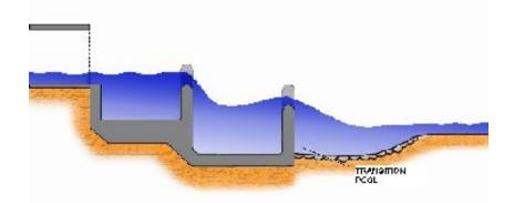
FIGURE 2 – TYPICAL PLUNGE POOL INSTALLATIONS
